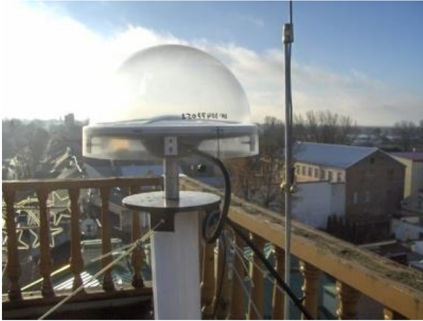
Fot. 1 Stacja referencyjna GPS (zdjęcie poglądowe).
