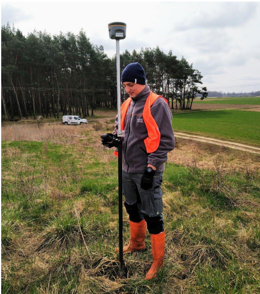
Fot. 2 Pomiar metodą statyczną (zdjęcie poglądowe).
